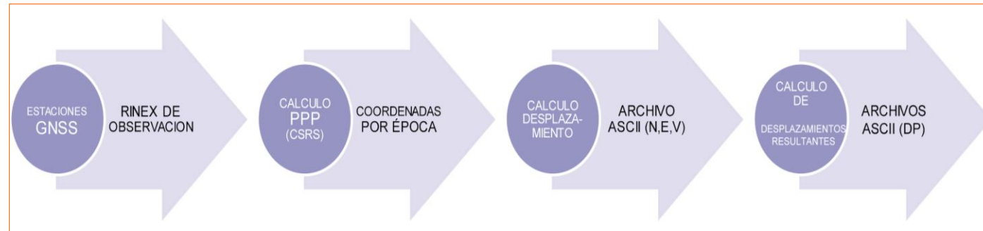
Figura 3. Proceso para obtener desplazamientos resultantes a partir de archivos de observación
